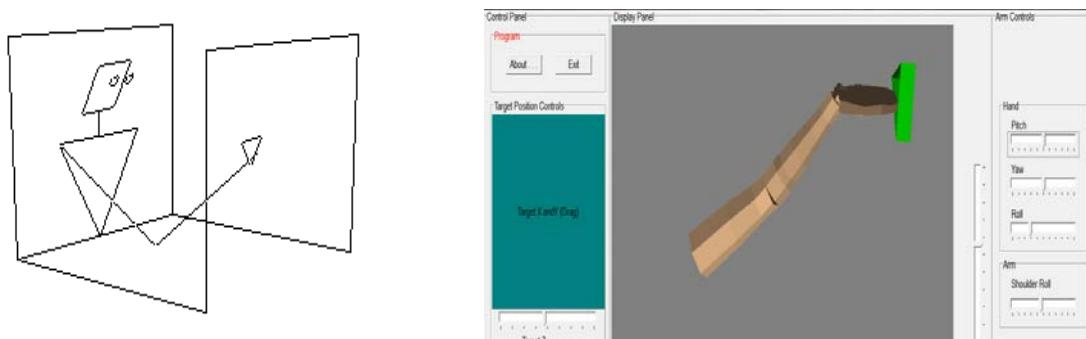
Slika 16. Little Man iz simulacije ArmOne, Powers (1989), i ArmTrackTarget, Model ruke s 14 stupnjeva slobode Powers (2008).
