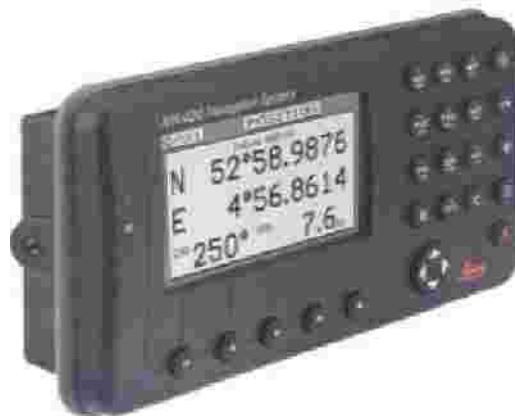
Slika 46. AIS, klasa B, prikaz podataka na displeju
