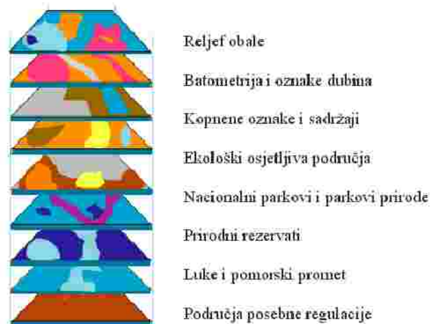
Slika 35. Razine vektorske elektronske navigacijske karte
