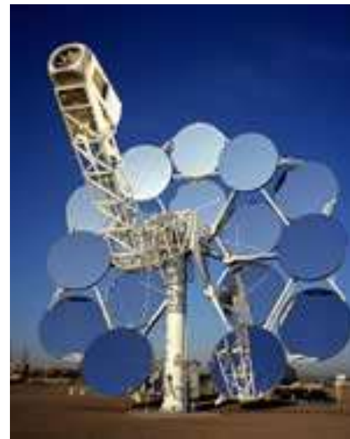
"Dish" sustavi prate kretanje Sunca i na taj način fokusiraju sunčevo zračenje
