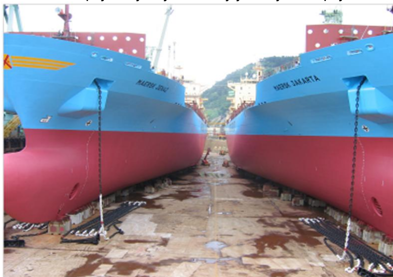
Razvlačenje sidrenog lanca i polaganje sidara na pod doka
